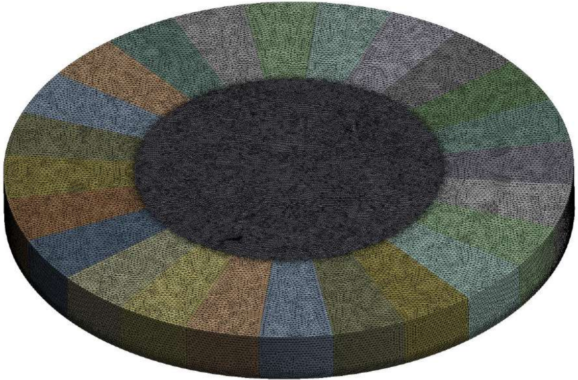
Рисунок 52 – Общий вид расчетной сетки аэродинамического домена
