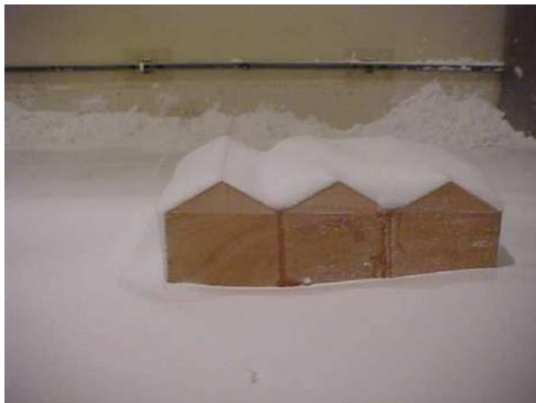
многопролетное здание с двускатными покрытиями
