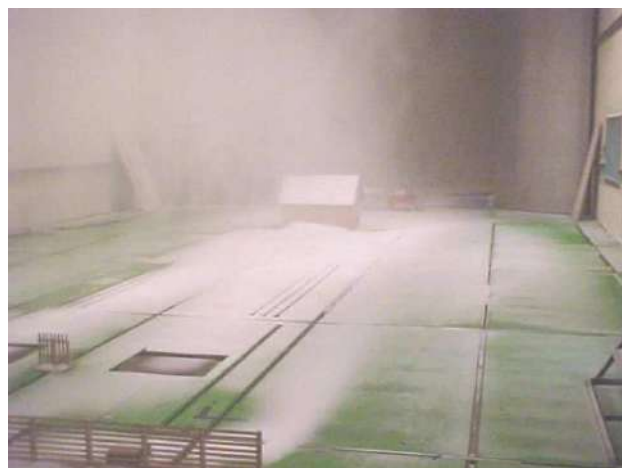
Рисунок 7 – Схема рабочей части климатического контура аэродинамической трубы “Jules Verne” центра CSTB (Франция) с установкой для физического (экспериментального) моделирования снегонакопления и снегопереноса (слева) и процесс эксперимента (справа) [139, 140]
