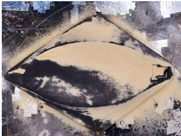
Рисунок 64 – Физически моделируемый коэффициент формы \mu_{\text{mr}} , направление ветра 327^\circ (без учета застройки)
